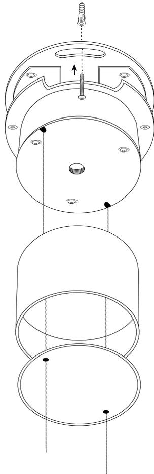
1. Den Baldachin an der Deckenbefestigungsplatte festhalten und das Gehäuserohr zusammen mit dem Cover nach unten abziehen (Magnetbefestigung).
