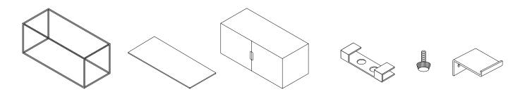
Jede Konfiguration hat als Basis ein Gestell. Verbinde Gestelle mit den beigeleten Verbindungs-Clips / Each configuration has a frame as a base. Connect the frames with the enclosed connection clips
