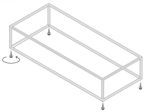
Die Stellfüße dienen der waagerechten Ausrichtung. Durch Drehen der Stellfüße können Unebenheiten im Boden ausgeglichen werden. Nimm dir eine Wasserwage zur Hand und richten Sie die Gestelle waagerecht aus / The feet serve for horizontal alignment. By turning the feet unevenness in the ground can be compensated. Pick up a spirit level and align the frames
