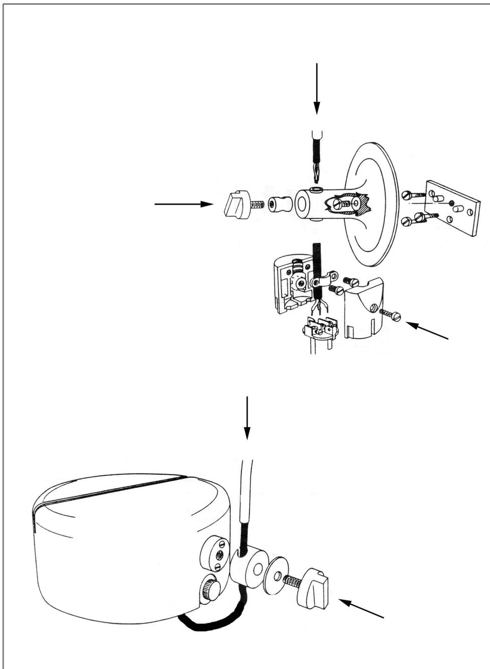
Per la sicurezza elettrica ed il corretto montaggio della lampada seguire la sequenza delle immagini.
